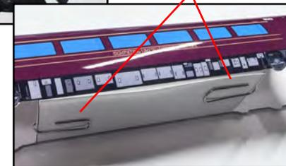
④前部パーツは、少し丸みを帯びるように折り曲げ、写真のように糊づけしていきます。
