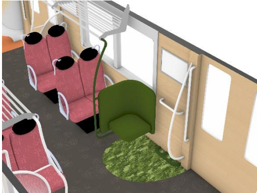
ベビーカー・大型荷物対応スペース
